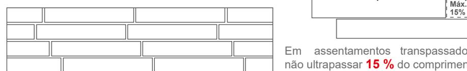
Em assentamentos transpassados, não ultrapassar **15 %** do comprimento da peça.
